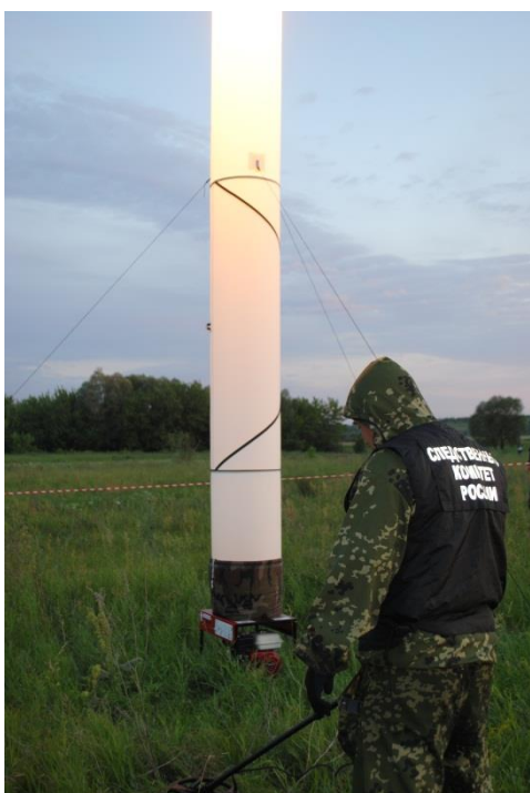
Следователи-криминалисты испытывают световую башню для осмотра места происшествия с применением металлоискателя в темное время суток
